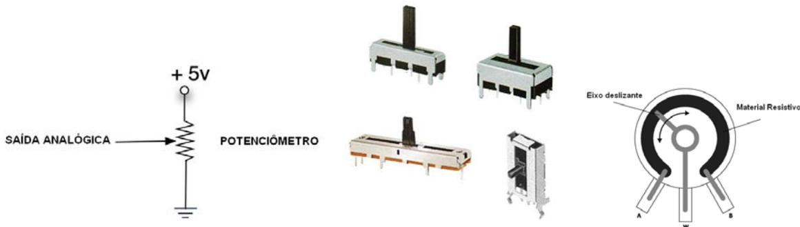
Figura 2.31 – Diagrama Esquemáticos e aspecto de potenciômetros lineares
